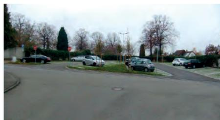
dung der Parkplätze erfolgt über eine umläufige Fahrspur mit Einbahnstraßenregelung. Die Parkplätze sind mit Rasenfugenpflastern hergestellt. Beleuchtet wird die Anlage mit einer energiesparenden und umweltfreundlichen LED- Beleuchtung. Die Bepflanzung mit Bäumen und Bodendeckern wurde abschließend vom Bauhof der Gemeinde ausgeführt.
